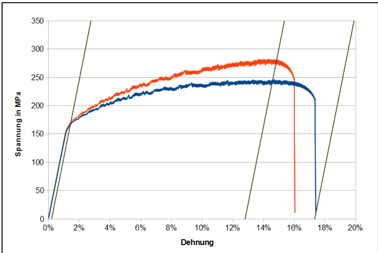
Abb. 6: Spannungs-Dehnungs-Diagramm der Aluminiumprobe; blau: technisch, rot: wahr.
