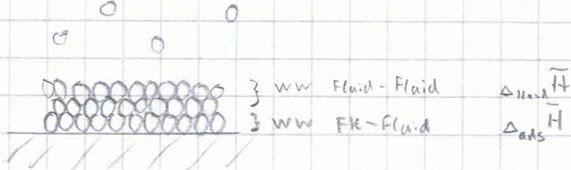
für Analyse der 1. Schicht: Adsorptionsenthalpie
