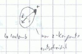
Feld  $E_i$ : erzeugt durch Punktladung  $q$  auf deren Oberfläche (Coulomb,  $r=a$ )
